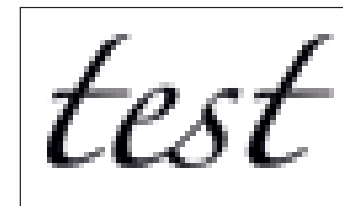
Resultierende Bildstruktur aus Pixelrasterweite 6 µm ohne Beugung
