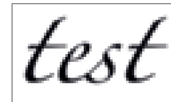
Resultierende Bildstruktur aus Pixelrasterweite 6 µm und Beugungsscheibchen 6 µm
