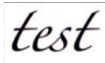
Resultierende Bildstruktur aus Beugungsscheibchen 6 µm ohne Pixelraster
